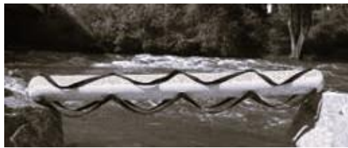
FIGURA W46. Dispositivo inflable de recuperación de víctimas (IVRD) que se despliega en un sistema hidráulico de baja presión.
