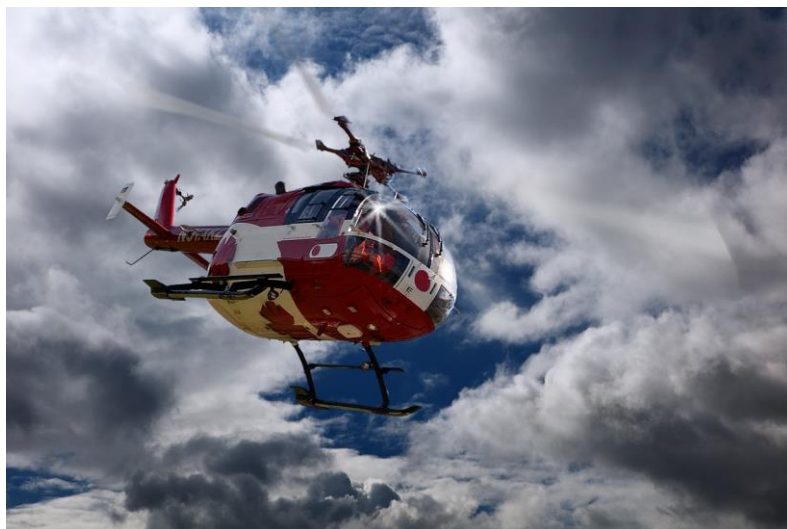
FIGURA W81. Helicóptero de rescate equipado con polipasto.
