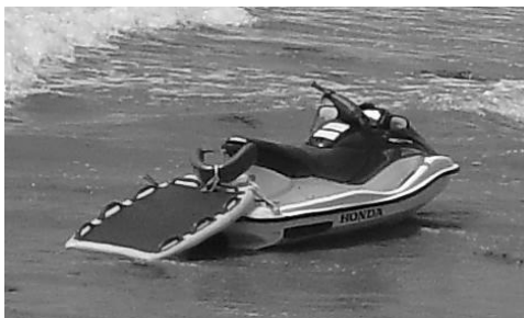
FIGURA W51. Moto acuática (PWC) equipada con un trineo de rescate.
