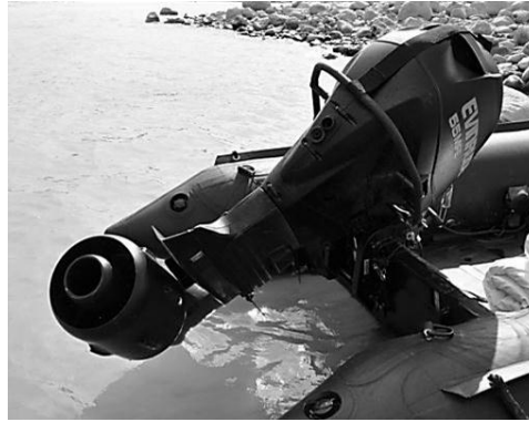
FIGURA W48. Motor fueraborda multicomcombustible de dos tiempos Evinrude de 55 hp con impulsor cubierto, que supera obstáculos sumergidos y es seguro para operar cerca de nadadores.
